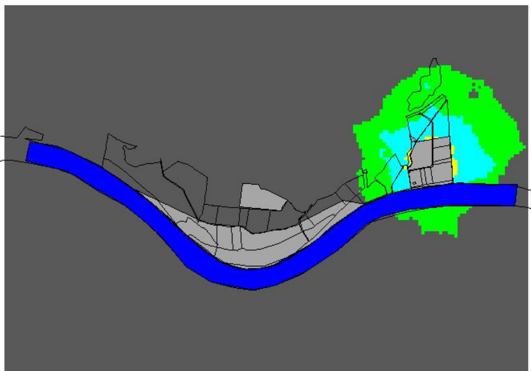
Figuur II.11: Totale bijdrage PM 10 aanlegactiviteiten oost
